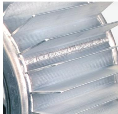
Функция Quattro Pulse™ (Квадро Импульс) – это одно из последних достижений Migatronic в рамках MIG/MAG сварки. Данная система позволяет получать сварной шов такой же структуры как при TIG сварке и гарантирует высокую степень проплавления.
