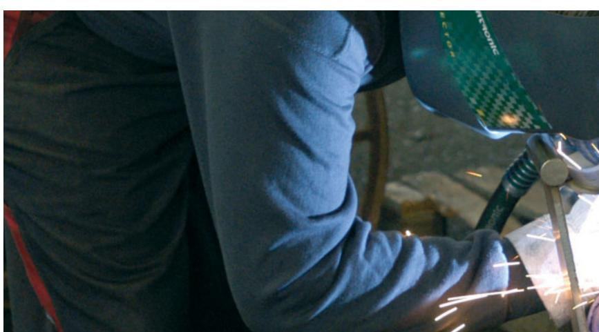
Сварка больших алюминиевых резервуаров из закалочного материала. Сварочный аппарат оснащен блоком водяного охлаждения и горелкой Push Pull «тяни–толкай» для проволоки диаметром до 1.2 мм.
