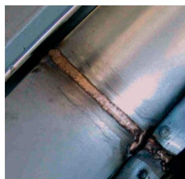
MIG-пайка – это щадящая технология «холодного» соединения, которая наилучшим способом сохраняет механические свойства стали и защитное антикоррозийное покрытие поверхности металла.
